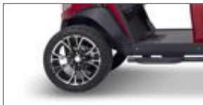
Wheel Lug Nut Torque: 105Nm - 120Nm
