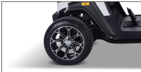
Wheel Lug Nut Torque: 105Nm - 120Nm
